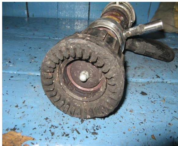
Рис. 2. Ствол РСКУ-50А с оплавленной полимерной муфтой поворотной голов- ки
