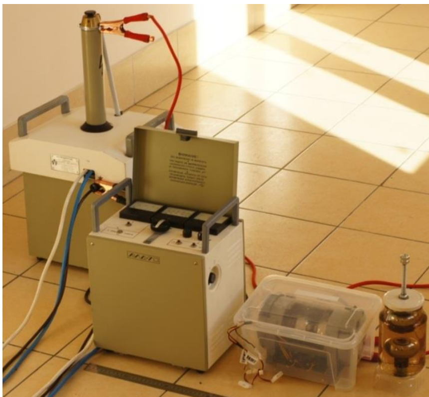
Рис. 1. Экспериментальная установка для определения электрической прочности смеси паров светлых нефтепродуктов с воздухом
